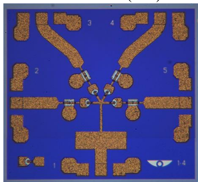
Размер кристалла 1,7×1,55×0,1 мм.
